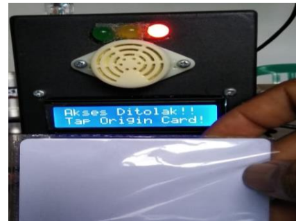
Gambar 3. Pengujian E-KTP dan RFID Tag Card sebelum didaftarkan
