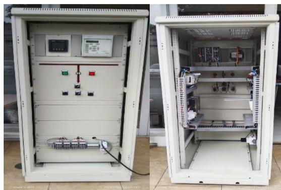
**Gambar 2. Miniature Sistem Proteksi tampak luar dan tampak dalam**
