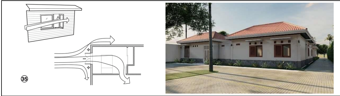
Gambar 8. Rekomendasi: optimalisasi sirkulasi udara (kiri); Hasil penerapan desain bukaan jendela lebar dan penggunaan boven untuk cross ventilation (kanan)
