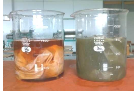
Gambar 7. Fiksasi dengan tawas dan ferro sulfat
