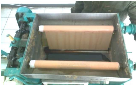
Gambar 6. Proses pewarnaan pada mesin jigger
