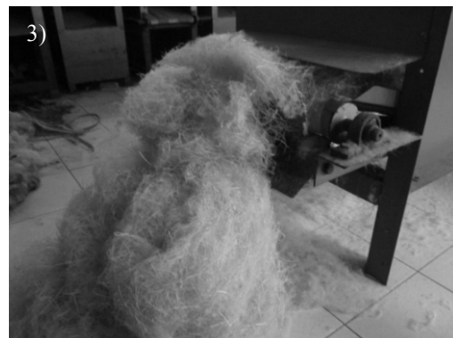
Gambar 2. Hasil pengolahan pada tiap tahapan serat bambu: 1) Sebelum proses softening ; 2) Setelah proses softening ; 3) Setelah proses opener .
