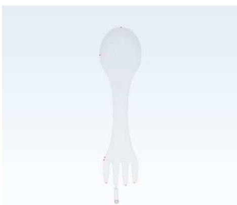
Gambar 6. Cacat air traps lokasi gate 2.
