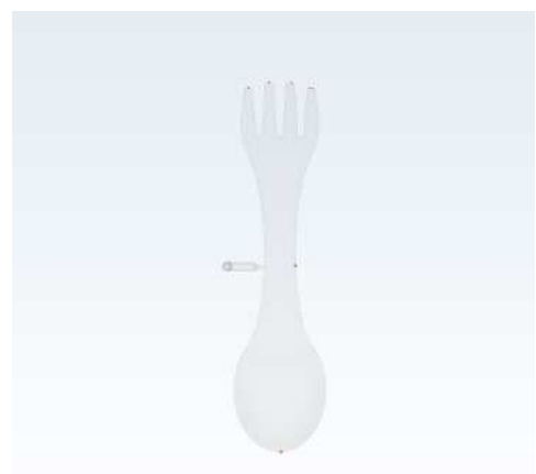
Gambar 9. Cacat air traps lokasi gate 3.
