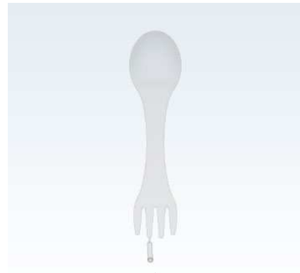
Gambar 7. Cacat weld line lokasi gate 2
