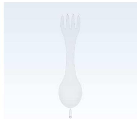
Gambar 3. Cacat air traps lokasi gate 1
