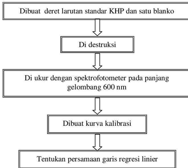
Gambar 1. Diagram alir pembuatan kurva kalibrasi pengujian COD
