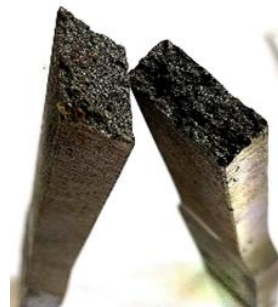
Gambar 9. Bentuk patahan uji tarik dengan penambahan (a) 3% Mg dan (b) 5%
