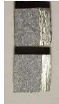
Gambar 9. Bentuk patahan uji tarik dengan penambahan (a) 3% Mg dan (b) 5%
