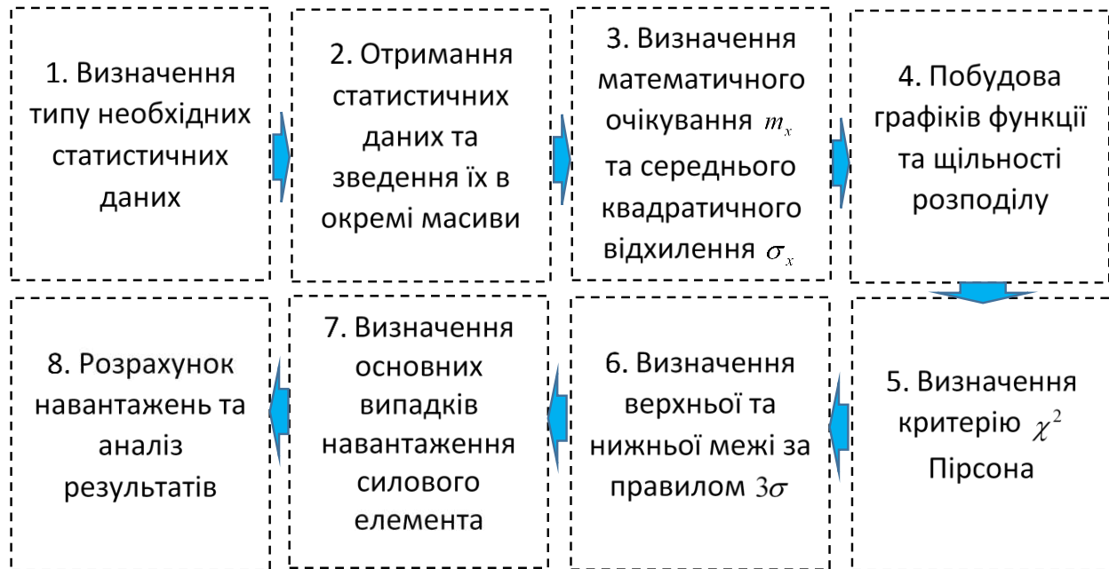
Рисунок 1 – Алгоритм виконання методики обробки експлуатаційних даних польотних циклів для попереднього оцінювання можливості збільшення призначеного ресурсу силовим елементам
