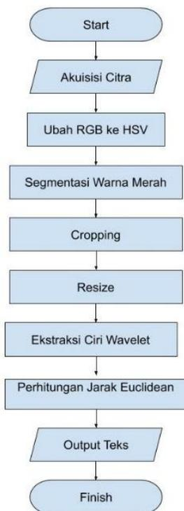
Gambar 1 Diagram Alir Proses Deteksi
