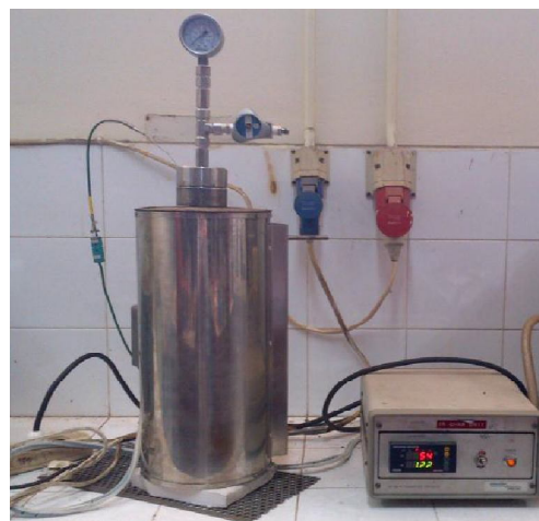
Gambar 3. Skema peralatan proses hidrotermal
