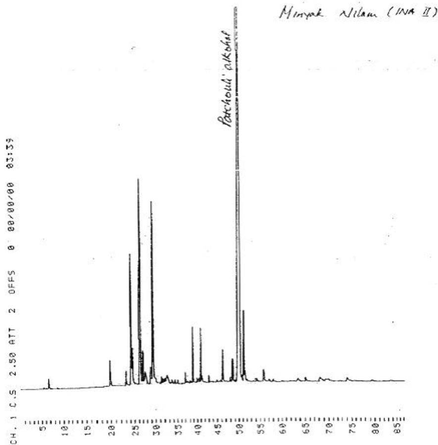
Gambar 5. Kromatogram gas kromatografi minyak nilam
