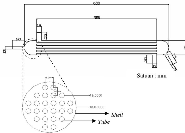
Gambar 2. Desain penampang samping dan tata letak *tube* pada kondensor
