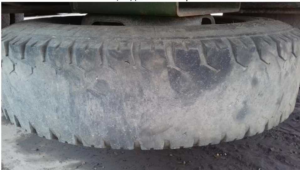
Мал. 4. – Протектор шини Бел-114 після 15 000 км пробігу у складі напівпричепа «ВАРЗ-НПВ 6009»
