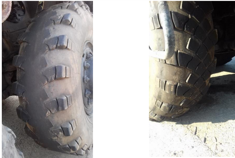
Мал. 6. – Протектор шини 18.00-24 E2 AOTAI (справа) та 18.00-24 E2 ARMFORCE (зліва) після пробігу близько 10000 км
