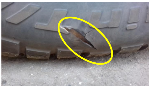
Мал. 9. – Механічне ушкодження бокової частини шини BF Goodrich Mud-Terrain T/A LT 225/75R16.
