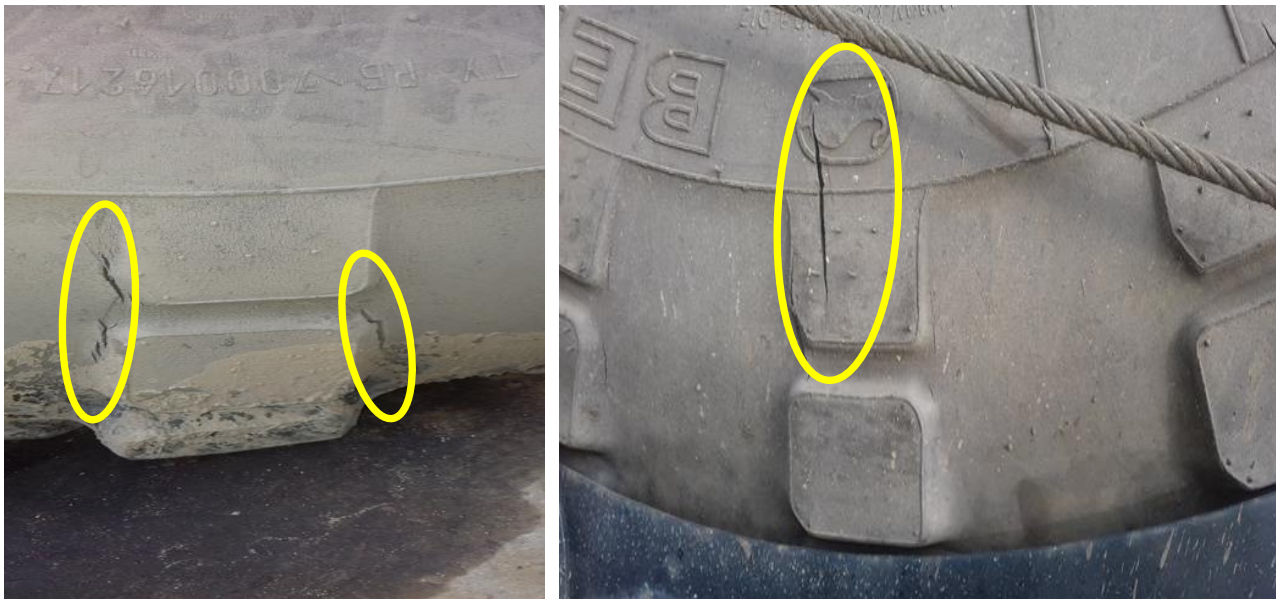
Мал. 2. – Розтріскування пневматичної шини Бел-66А при експлуатації у складі сідельного тягача «КрАЗ 6446»
