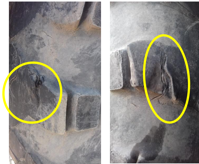
Мал. 7. – Типові механічні пошкодження пневматичних Шин 18.00-24 E-2 AOTAI та 18.00-24 E-2 ARMFORCE
