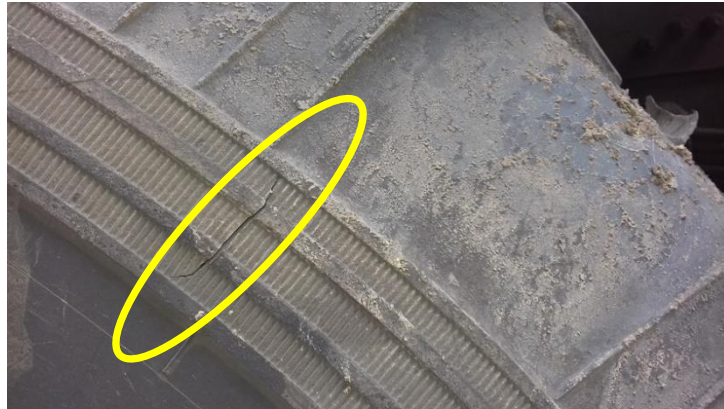
Мал. 3. – Розтріскування бокової частини пневматичної шини ИД-370
