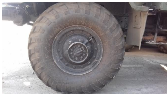
Мал. 8. – Пневматична шина 320-457 (12.00-18) ARMFORCE
