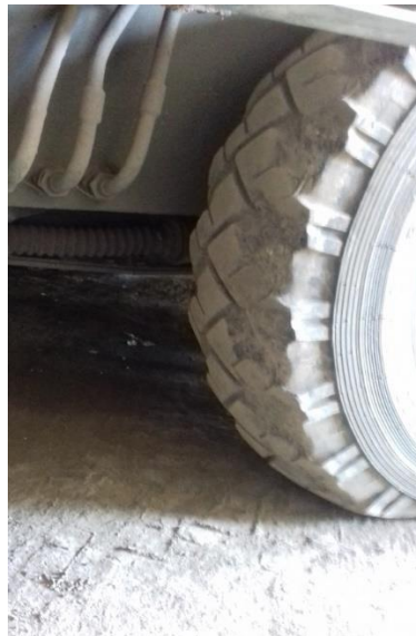
Мал. 1. – Руйнування протектора шини 12,00R20
