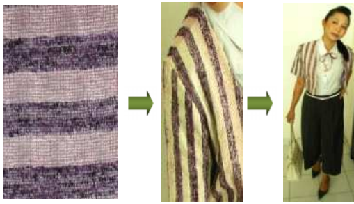
Gambar 13. Tenun ATBM, Anyaman polos (Benang Lusi: Kapas, Benang pakan: Benang fancy 1-ungu tua; Benang fancy 2-putih, pink, hitam)
