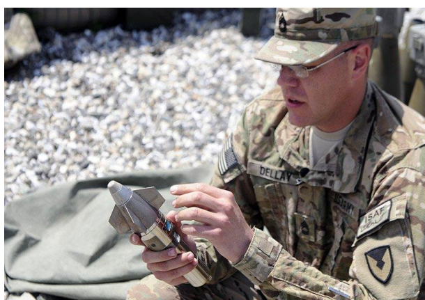
Рис. 1. XM1156 PGK (PROJECTILE GUIDANCE KIT, комплект точного наведення снаряду)
