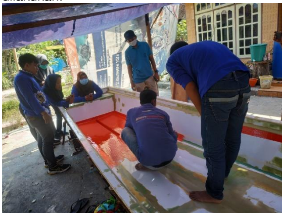
Gambar 5. Pelapisan cetakan ( mold ) dengan menggunakan mirror glaze
