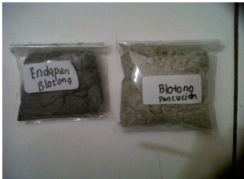
Gambar 1. Blotong garam (kanan) dan endapan pemurnian (kiri)
