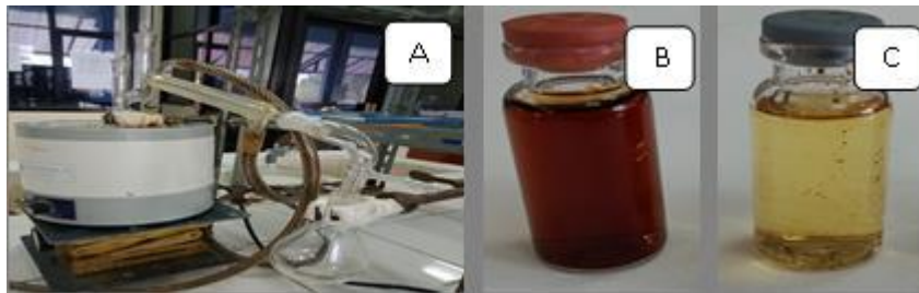
Gambar 1 A) Seperangkat alat destilasi; B) Asap cair grade 3; C) Asap cair grade 2
