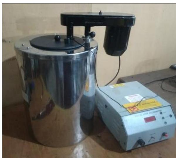
Gambar 3. *Bomb calorimeter*
