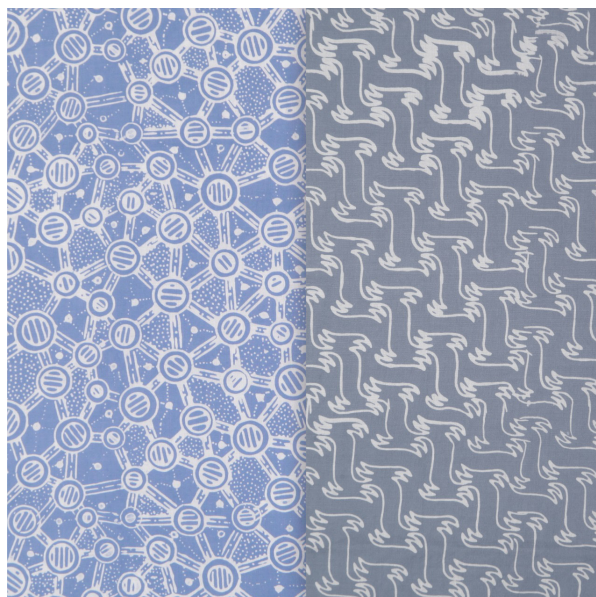
Gambar 7. Perbandingan Hasil Pewarnaan Warna biru Indigosol pada Kain Batik Keterangan: kiri (warna dengan sinar matahari penuh/musim panas); kanan (warna dengan sinar matahari kurang/mendung, musim hujan)
