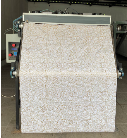
Gambar 4. Mesin fotonik batik yang terpasang batik
