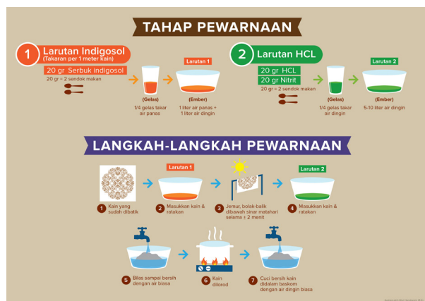
Gambar 5. Bagan Proses Pewarnaan kain batik tradisional dengan sinar matahari langsung (Sumber: Ilustrasi by: Wuri Handayani, 2020)
