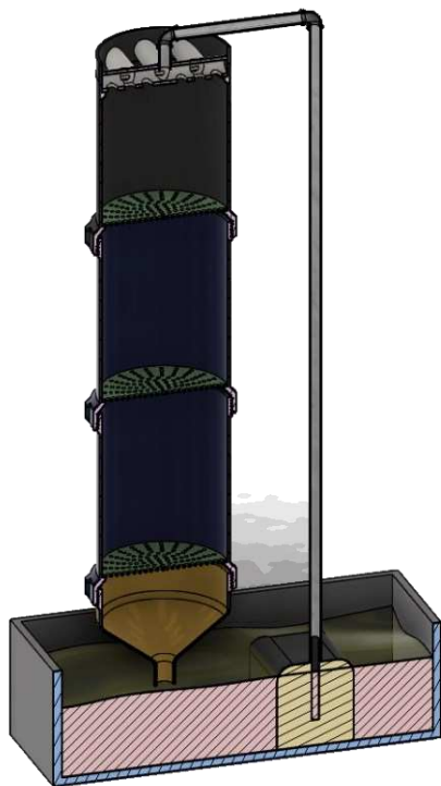
Gambar 2. Skema Penampang Kolom Adsorpsi Portabel Tersirkulasi
