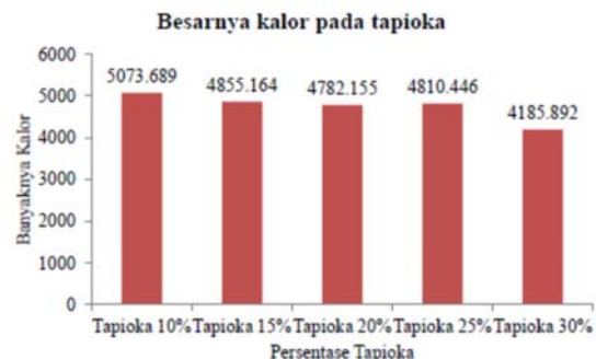
Gambar 5. Grafik nilai kalor terhadap persentase binder tapioca Besar kalor yang dihasilkan dari bioarang adalah >5000 kal/g sedangkan dari biomasa >3000 kal/g (Widarto, 1995).
