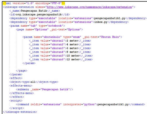
Gambar 1. Source code interface ekstensi yang dibuat pada penelitian ini
