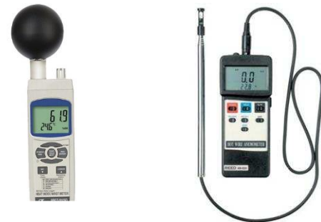
Gambar 5. Alat pengambilan data fisik lingkungan ( WBGT meter dan hot wire anemometer )
