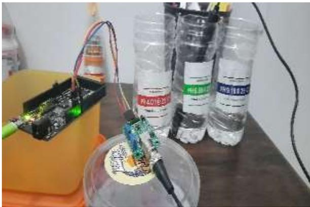
Gambar 3. Proses kalibrasi menggunakan larutan buffer.
