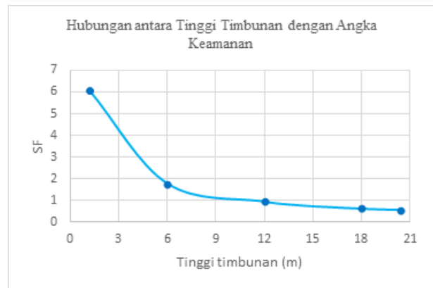
Gambar 12. Grafik hubungan antara tinggi timbunan dan angka keamanan terhadap daya dukung tanah.
