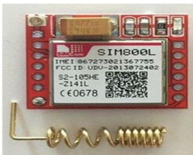
Gambar 2. Modul GSM SIM800L GSM GPRS
