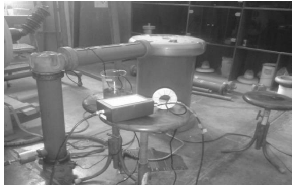
Gambar 5. Rangkaian pengujian partial discharge
