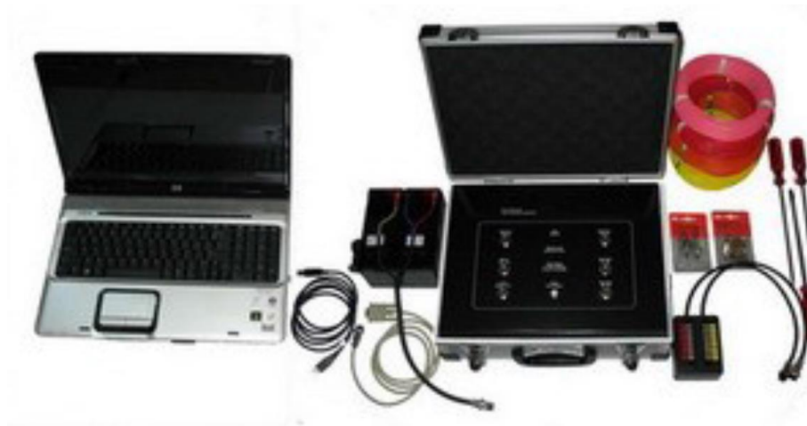
Gambar 2. Geolistrik S-Field Automatic Multichannel (Kamur et al., 2020)
