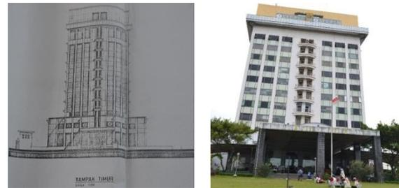
Gambar 2.1 (a) Denah asli gedung tampak timur dan bentuk nyata saat ini (Sumber : Denah dari KBSRT STT-PLN)
