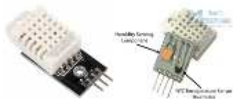
Gambar 6. Sensor DHT22 dan penyusunnya.
