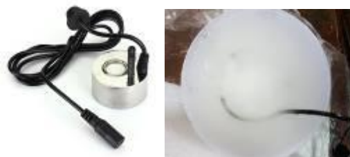
Gambar 5. Ultrasonic atomizer dan kabut yang dihasilkan.
