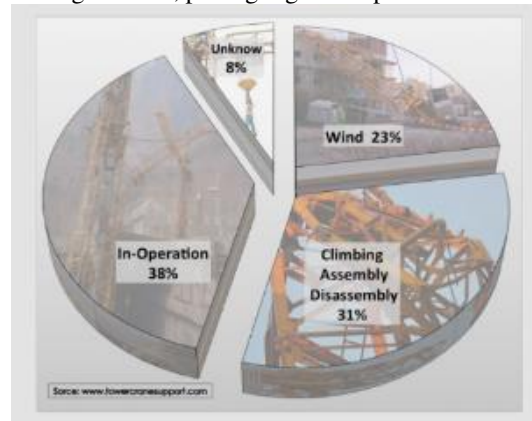
Gambar 1. Grafik Penyebab Kerusakan Tower Crane.
