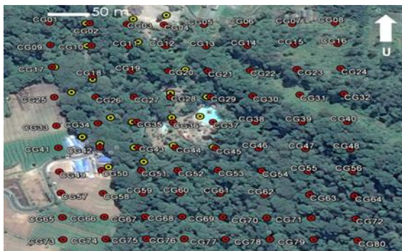
Gambar 1. Desain sistem grid untuk survei metode gaya berat
