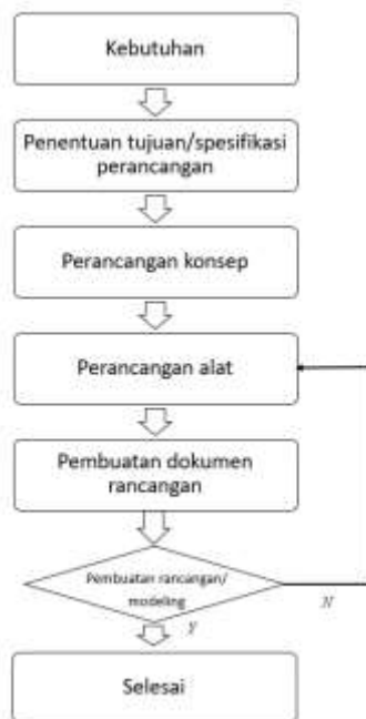
Gambar 1. Diagram alir proses perancangan alat
