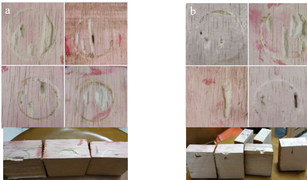
Gambar 3. Uji serangan rayap pada sampel uji berpengawet nanokitosan dengan waktu penyimpanan (a) 0 hari (b) 7 hari Figure 3. Termite attack test on samples treated by nanochitosan with the storage time of (a) 0 days (b) 7 days
