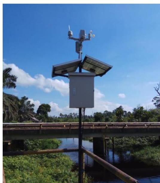
Gambar (Figure) 2. Stasiun hidrometeorologi (*Hydrometeorological station*) (Sumber /source: foto pribadi)
