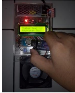
Gambar 12 Hasil Akhir Alat Gas Terdeteksi
