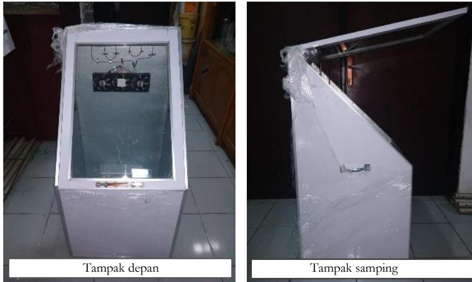
**Gambar 3. Pengering kayu skala mikro dengan energi cahaya matahari**
