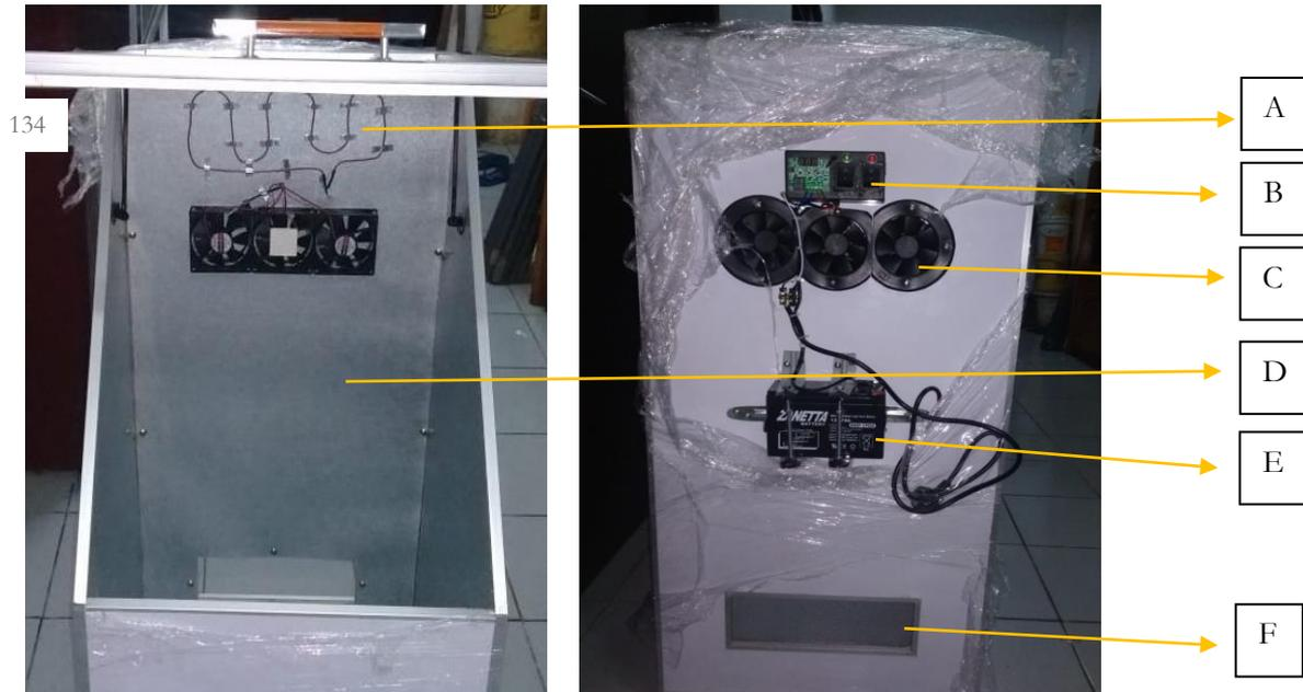
Keterangan (*Remarks*): A. Elemen pemanasan; B. Indikator suhu dan sensor suhu; C. Kipas; D. Lapisan aluminium; E. Aki Kering; F. Ventilasi
