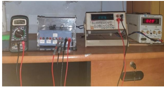
Gambar 1. Rig Experimen penelitian pengisian ulang baterai alkalin yang terdiri dari pembangkit tegangan (voltage generator), Ampere meter, Volt meter dan timer
