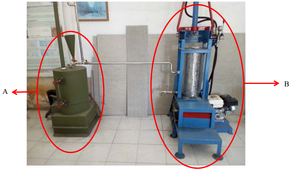
Gambar 1. Prototipe alat pres Tengkawang bertenaga hidrolik (A = unit boiler dan B = unit pengepres); Sumber foto : dokumentasi pribadi.
