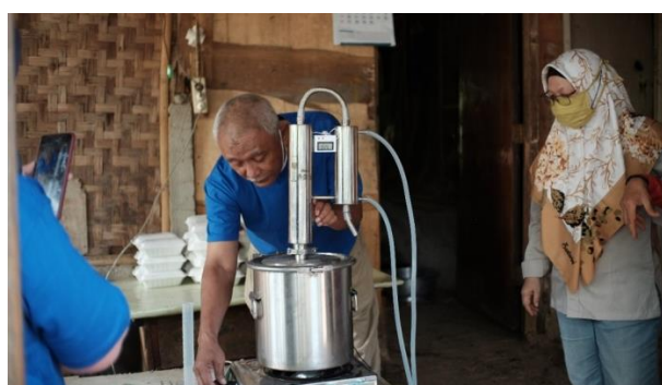
Gambar 3. Alat Distilasi pada Pengolah Cuka Kayu
