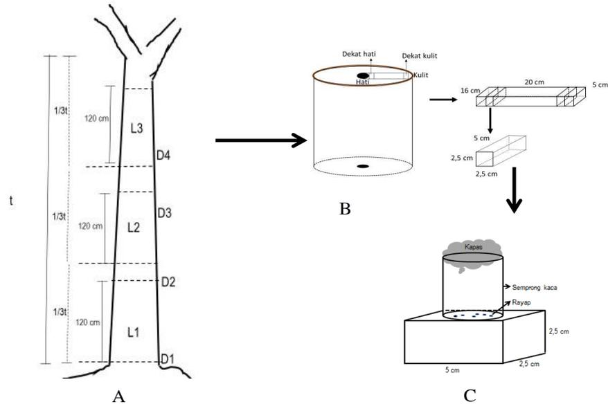
Gambar 1. Pengambilan sampel kayu (A), pembuatan contoh uji (B) dan pengumpanan dengan organisme rayap kayu kering (*Cryptotermes cynocephalus*) (C)
