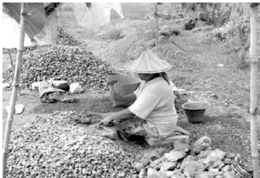
Gambar 1. Pekerja memecah batu dengan menggunakan palu, tanpa memakai pelindung tangan dan kaki, yang dapat menyebabkan luka akibat terkena palu dan percikan batu.
