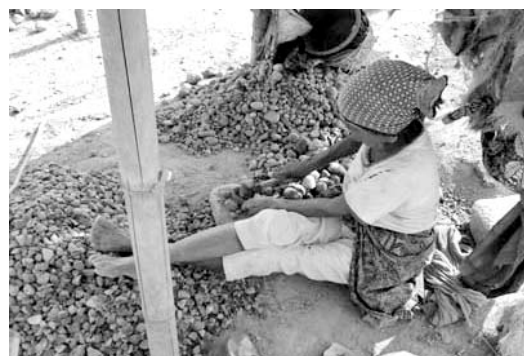
Gambar 1. Pekerja memecah batu dengan menggunakan palu, tanpa memakai pelindung tangan dan kaki, yang dapat menyebabkan luka akibat terkena palu dan percikan batu.
