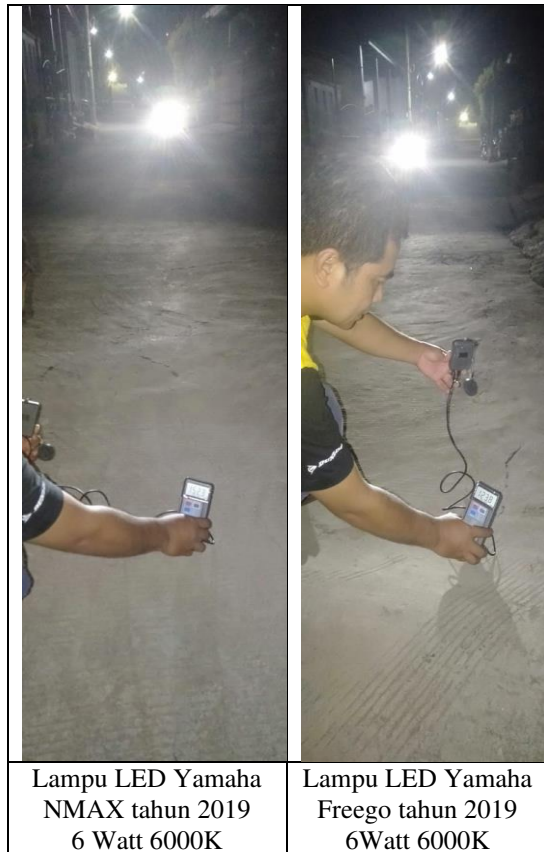
Gambar 13. Pengukuran intensitas cahaya (lux) lampu LED pabrikan.
