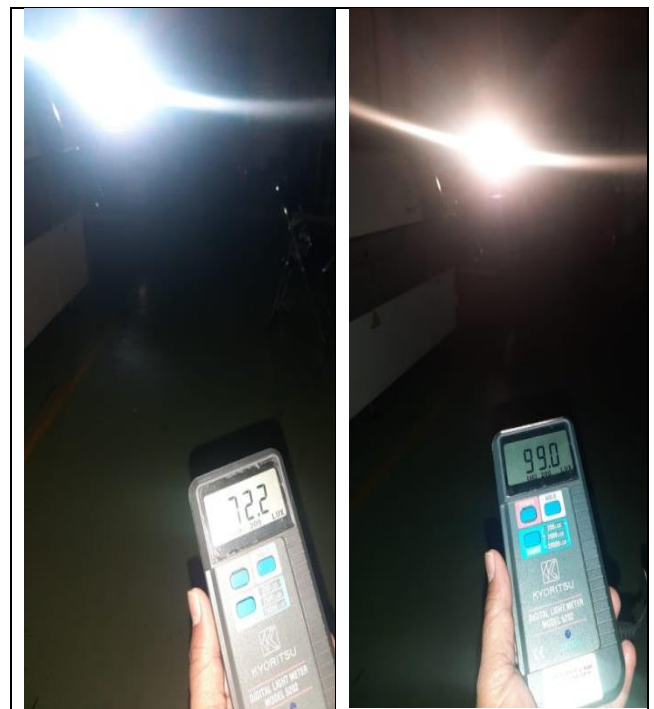
Gambar 11. Pengukuran intensitas cahaya (lux) sepeda motor pabrikan.
