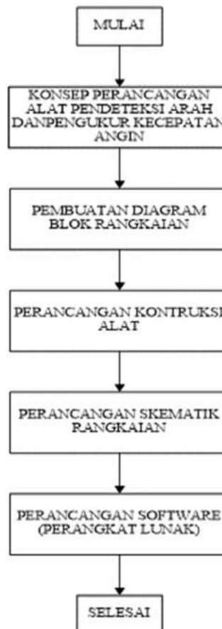
Gambar 1. Tahapan Perancangan Alat
