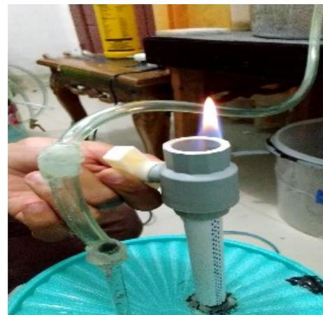
Gambar 3. Uji Nyala Biogas
