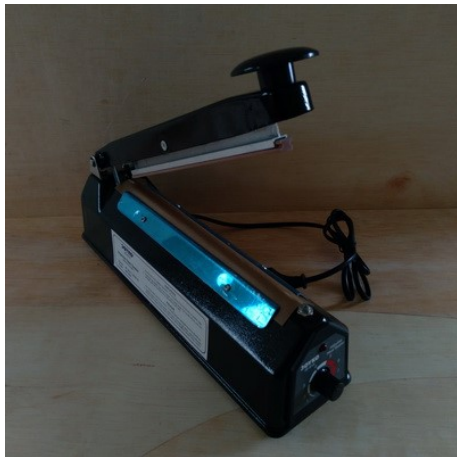
Gambar 3. Impuls sealer dengan panjang elemen 20 cm
