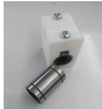
Gambar 5. Pemasangan linear bearing pada sliding block
