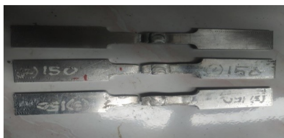
Gambar 14. Spesimen uji tarik 150 A setelah putus
