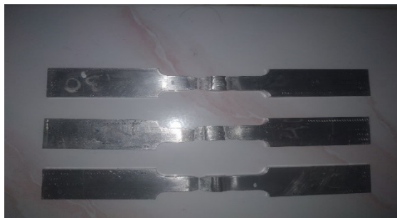
Gambar 12. Spesimen uji tarik 130 A setelah putus
