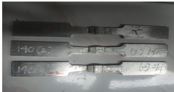
Gambar 13. Spesimen uji tarik 140 A setelah putus
