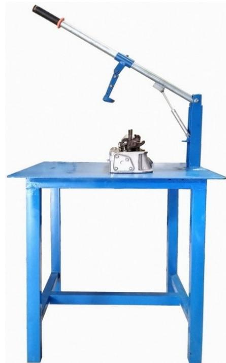
Gambar 5. Hasil rancang bangun alat pembuka katup menggunakan mekanisme tuas
